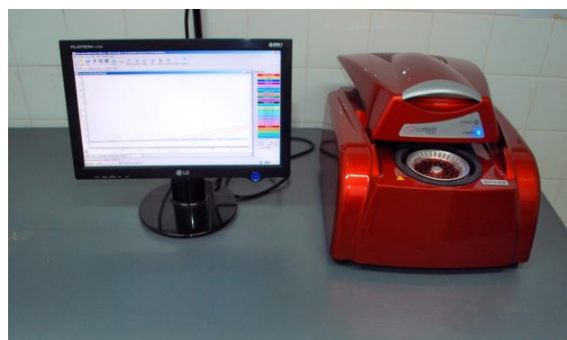
Figura 4. Termociclador en Tiempo Real donde se lleva a cabo la reacción de qPCR. Cuenta con un rotor donde se ubican las muestras a analizar (Tubos de 0,2 mL), un sistema óptico (canales con diferentes longitudes de onda UV a infrarroja) y un software para analizar la reacción.
